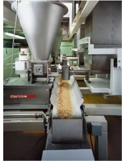
**C**on las básculas de dosificación diferencial DIW y los mezcladores en continuo GCM Gericke combina dos tipos de aparatos óptimamente adaptados entre sí para procesos delicados con porcentajes pequeños de formulación e incluso con la adición de líquidos. Todos los requisitos respectivos a la homogeneidad se cumplen de forma óptima. Ventajas sobre los procesos por lotes:
