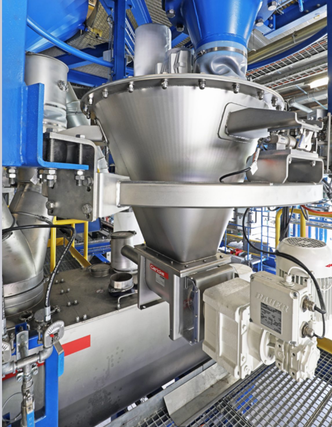
Anlagenbeispiel in der Bauchemie (Dosierung in einen kontinuierlichen Mischer)
