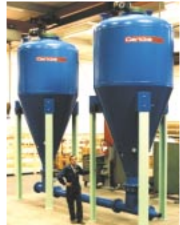
Kontinuierliche Förderung von Flugasche, 130 m 3 /h, mit Doppelsender.
