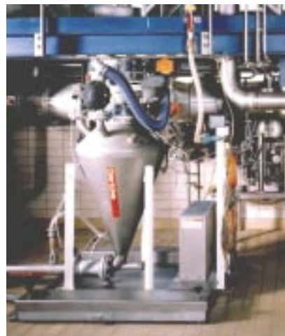
Chemische Produkte: Pneumatische Dichtstromförderung mit Wägung und Registrierung der Durchlaufleistung
