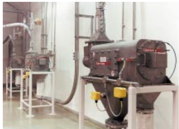
Inline-Wirbelstromsiebmaschine, eingebaut direkt in Niederdruck- oder Saugförderung.
