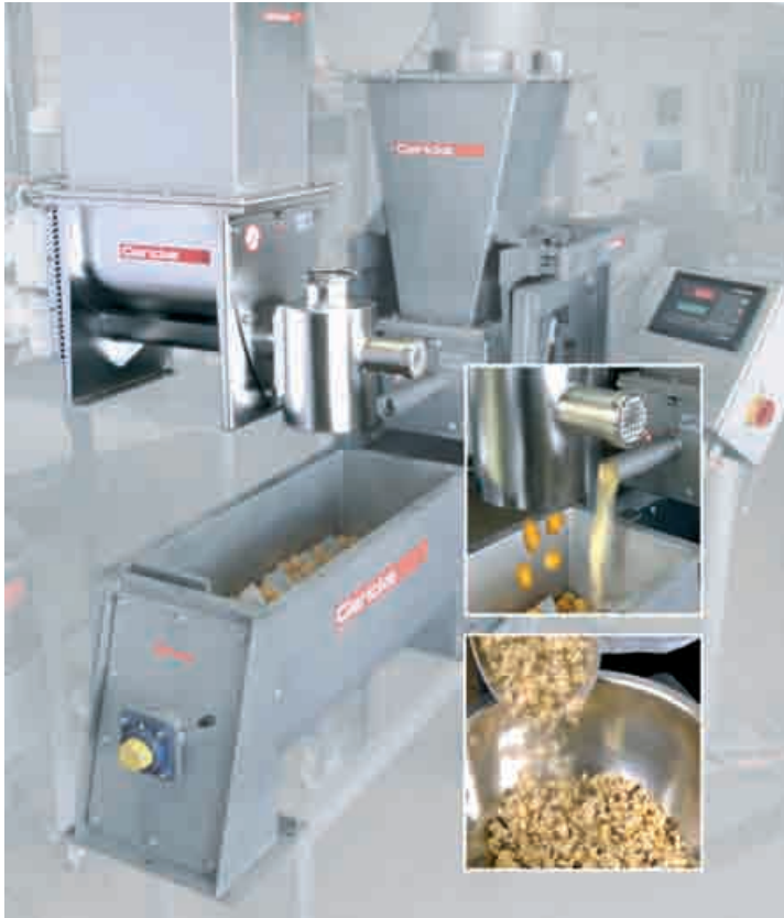
Gericke-Dosiergeräte beschicken kontinuierliche Mischer GCM
