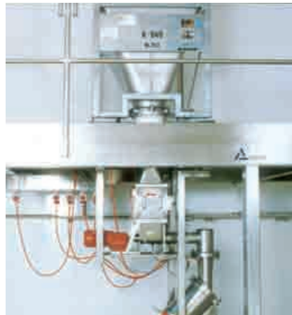
Pharma-Umfüllstation mit Dosiergerät und Siebmaschine
