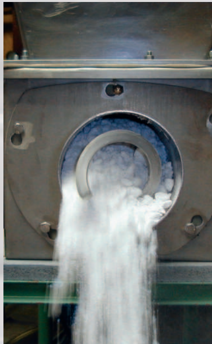
Die Schlägerleisten pressen den Filterkuchen durch das Raffelblech. Der Vorteil: Der Kuchen wird zerschnitten, ohne viel Feinkorn zu bilden. So lassen sich beispielsweise Fässer problemlos füllen.
