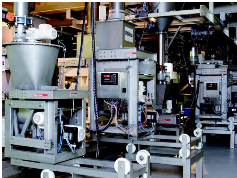
Verfahrbare Dosierwaagen mit Spiral- oder Schneckendosierer für Pulver und Rosinen
