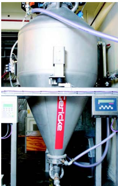
Fördersender Typ PTA-PL 1300 I mit Dichtstromförderer Pulse Line
