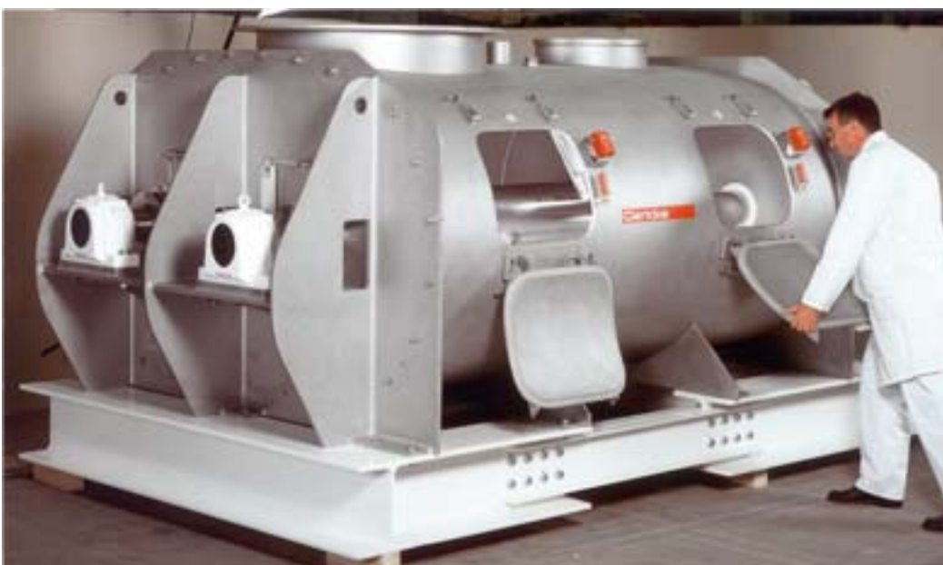
Der Doppelwellenmischer GMS ist mit zwei gegenläufig drehenden, überlappenden Mischwellen ausgestattet
