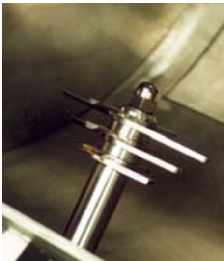
In Verbindung mit hochtourig rotierenden Zerhackern werden im GBM auch hochviskose Flüssigkeiten und Pasten dispergiert
