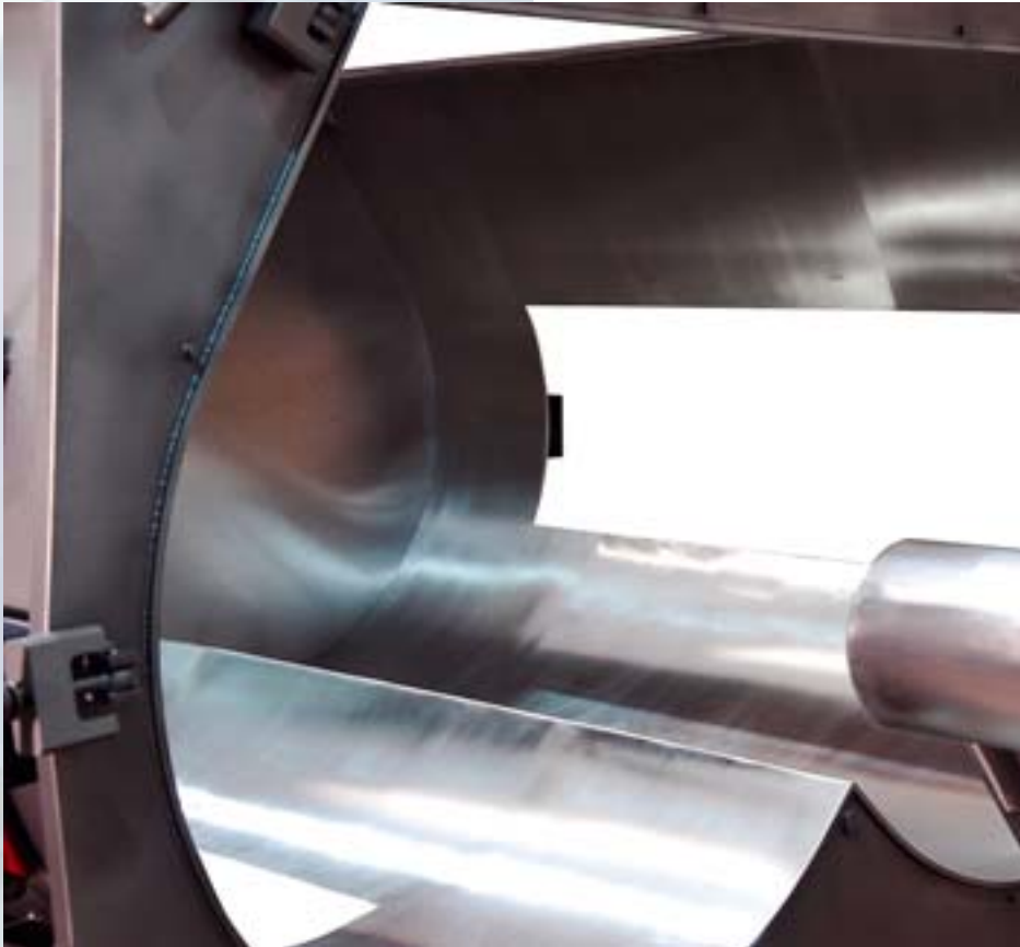
Blick in die horizontal angeordnete Mischkammer: Gut zugängliche Öffnungen erleichtern die Reinigung und Wartung der GMS-C- und GMS-ECD-Mischer
