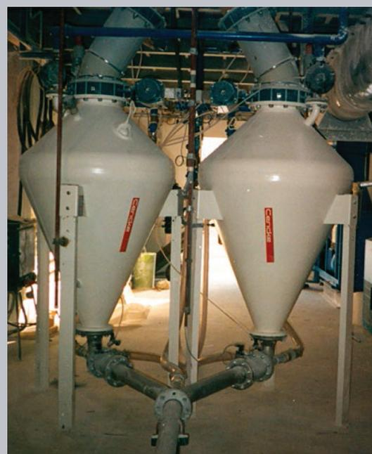
Ce système de transport Gericke très performant a une capacité de 20 t/h. Grâce à une grande concentration air/ produit, le transport se fait avec une faible quantité d'air et en utilisant de petits filtres. Le transport à vitesse lente permet une abrasion minimale de la tuyauterie et évite ainsi l'utilisation de coudes à grand rayon renforcés. Ce concept garantit un convoyage efficace, fiable et exempt de poussières même en cas de différences de température.
