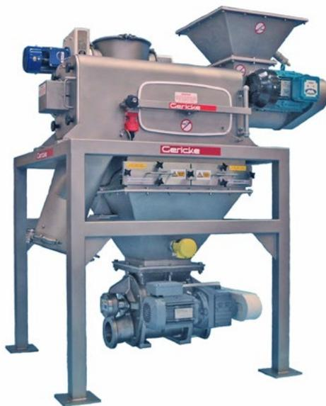
Zentrifugal-Siebmaschine mit Magnetabscheider und Durchblas-Zellenradschleuse
