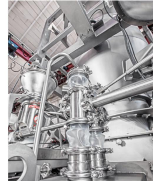
Die einzigartige Erfahrung von GERICKE auf dem Gebiet des kontinuierlichen Mischens und Dosierens hat zu einem neuen Ansatz bei Mischlösungen geführt. Mit dem TCM Turbo Compact Mischer können bis zu vier Ströme kontinuierlich gravimetrisch dosiert und gemischt werden. Bei minimalem Platzbedarf und hoher Dosiergenauigkeit.
