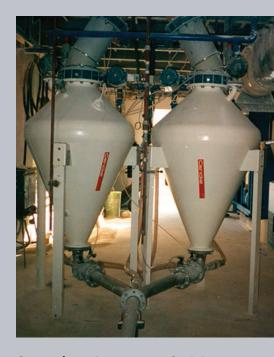
Ce système de transport Gericke très performant a une capacité de 20 t/h. Grâce à une grande concentration air/ produit, le transport se fait avec une faible quantité d'air et en utilisant de petits filtres. Le transport à vitesse lente permet une abrasion minimale de la tuyauterie et évite ainsi l'utilisation de coudes à grand rayon renforcés. Ce concept garantit un convoyage efficace, fiable et exempt de poussières même en cas de différences de température.
