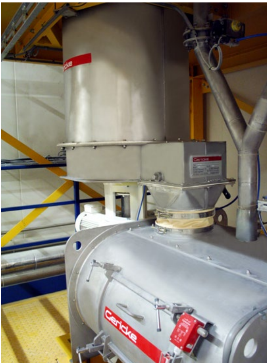
El sistema de evacuación con agitador RA alimenta el mezclador con yema pulverizada.
