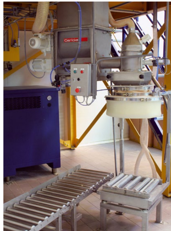
Sistema GDU 451 para el llenado de recipientes.
