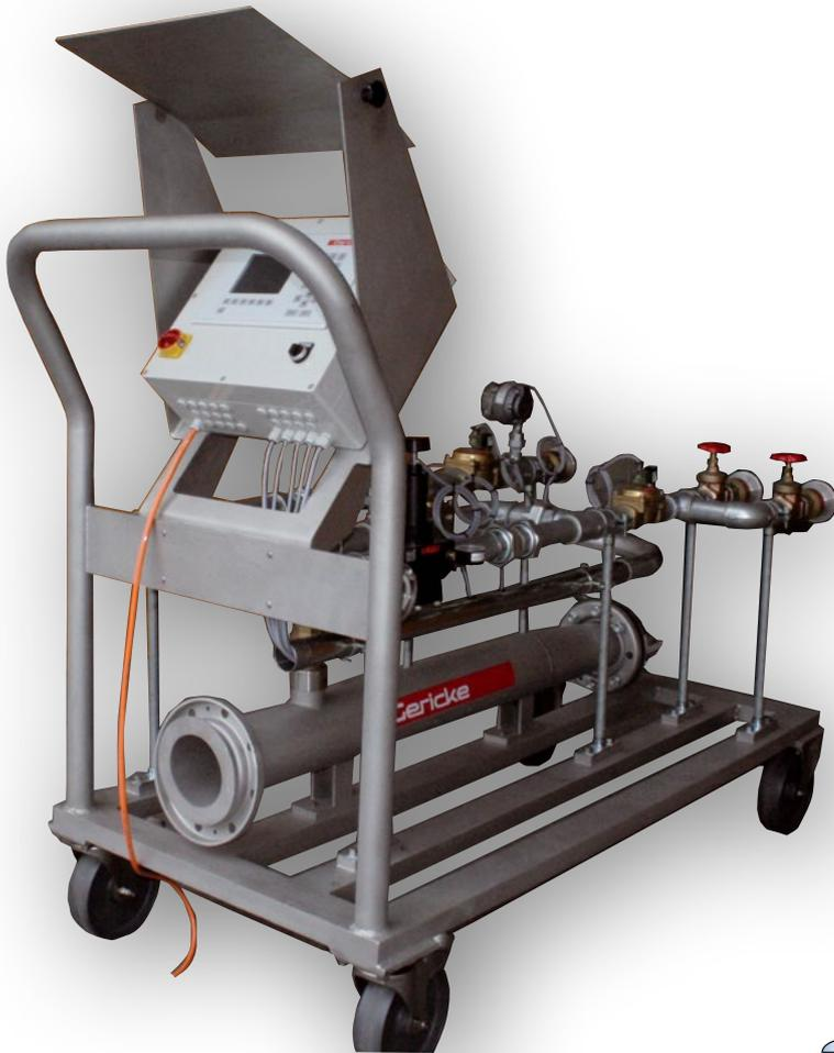
**E**l granulado de suplemento de detergente se suministra en un camión cisterna y se transporta neumáticamente a un silo. Este nuevo transporte cuidadoso por medio del sistema móvil de descarga de camión cisterna PTA-PL (Pulseline®) sustituye a la descarga directa de camión cisterna con altas velocidades de transporte que se utilizaba hasta la fecha, y permite una reducción del porcentaje de partículas finas de aproximadamente el 15%.
