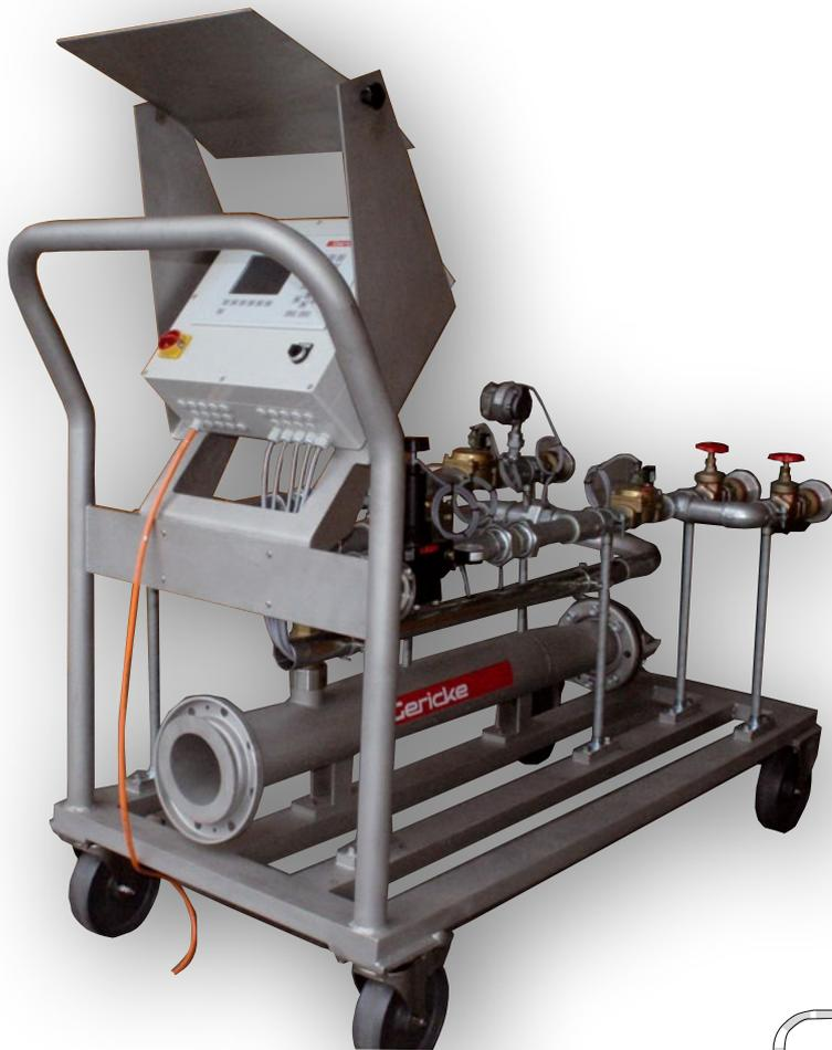
运输车辆送来洗涤粉，然后气力输送到贮料仓。改造前工厂使用的是高速卸料系统，其物料的磨损竟达15%！改造后使用PTA-PL移动卸料系统（PluseOR），从而送料轻柔。由料仓到搬运箱距离60m，这部分也是低速气力输送，其中进行了增压和注气。
