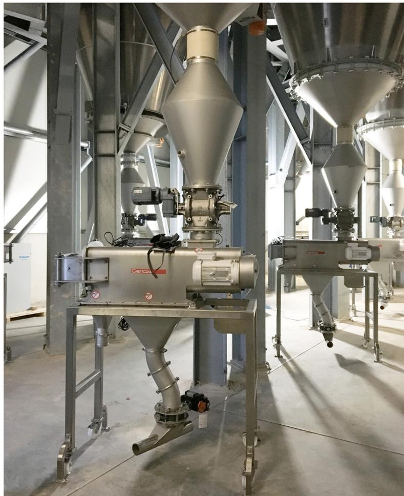
Gericke bietet seit über 50 Jahren Wirbelstrom Siebmaschinen für die Schüttgut- und Pulververarbeitungsindustrie an. Die umfassende Erfahrung aus erfolgreichen Projekten in der Lebensmittelindustrie, Chemie, beim Mühlenbau, in der Getränkeindustrie, Farbherstellung, Metalldruck und bei Tiernahrungsproduzenten ermöglicht uns, zuverlässige Systeme zu liefern.
